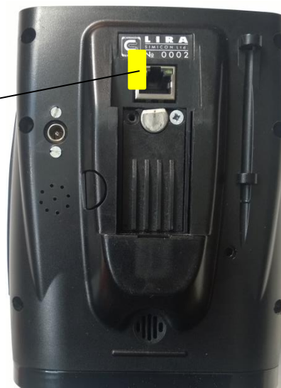
Slika 13. Postavljanje zaštitne markice na UTP priključak
